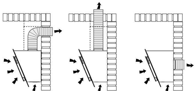
Abluft durch die Wand oberhalb der Haube, über ein im Schacht innen liegendes Abluftrohr
