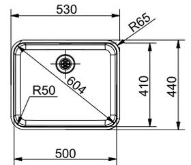
Elegantes Unterbaubecken mit besonders reinigungsfreundlichem Beckenradius. Das großzügige Beckenvolumen verleiht maximale Funktionalität. Ausgestattet mit einem hochwertigem Integralablauf.
