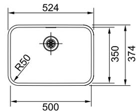
Elegantes Unterbaubecken mit besonders reinigungsfreundlichem Beckenradius. Das großzügige Beckenvolumen verleiht maximale Funktionalität. Ausgestattet mit einem hochwertigem Integralablauf.
