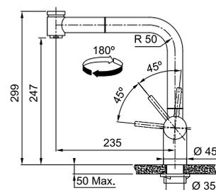
Massiv-Edelstahl Armatur radial gebürstet mit
